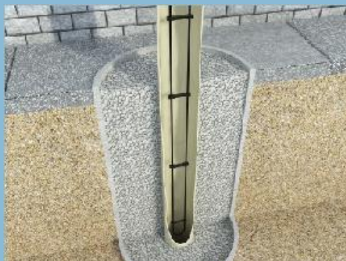
Ułożenie przewodu grzejnego poniżej poziomu terenu
