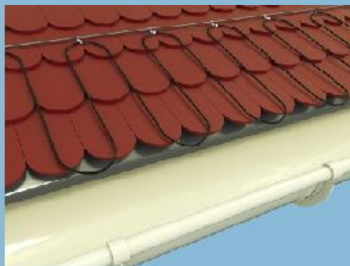
Przykład ogrzewania krawędzi dachu
