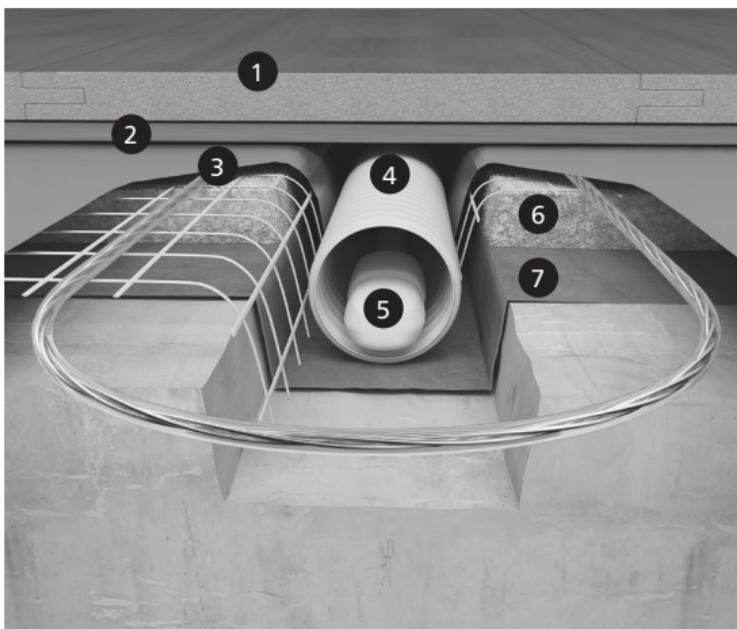
Sposób umieszczenia czujnika temperatury
