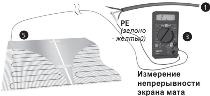
Если Непрерывность экрана измеряется омметром путём измерения сопротивления между экраном (PE) провода питания и алюминиевой фольгой в наиболее удалённом от «холодного соединения» фрагменте обогревательного матта.
